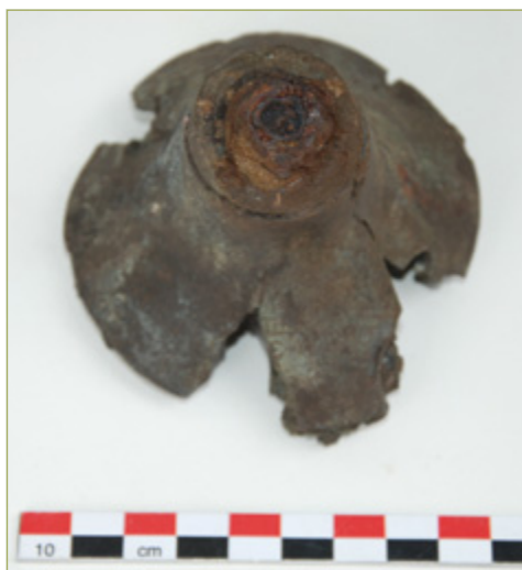
Afb. 9.26 Britse ontsteker van het type No. 117 III A voor 25-pdr granaat (vondstnummer 159) (foto RAAP).
